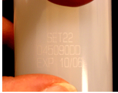
Bu markalama 10W güç kullanılarak 0.62 saniye devir hızında yapılmıştır.
